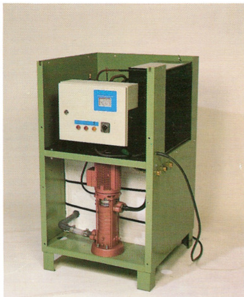
▲ Prozeßkühler EPC-L bzw. EPC-W Einkreis-System mit eingebauter Zirkulationspumpe zum Anschluß an Wärmetauscher oder Kühlbe- hälter, in luft- und wassergekühlter Ausführung.
