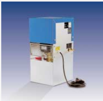
LWK - Luft-Wasser-Kühler ohne Kälteaggregat mit einer Kühlleistung von 2 oder 2,5 kW mit Tank und Pumpe. Die preiswerte Alternative für Anwendungen mit höheren Wassertemperaturen.
